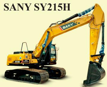
La SANY SY215H es una excavadora de 21.5 toneladas diseñada para trabajos exigentes en construcción y minería. Con su motor ISUZU 4HK1 de 178 HP y sistema hidráulico inteligente, ofrece fuerza, precisión y excelente eficiencia operativa.
